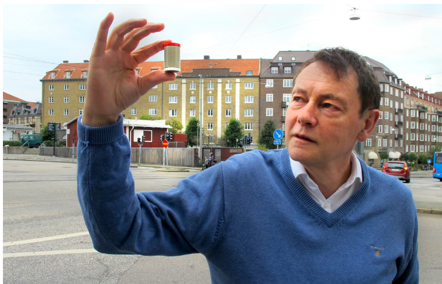
Martin Ferm, IVL Svenska Miljöinstitutet, med en diffusionsprovtagare som mäter kvävemonoxid och kvävedioxid – ett genombrott för att mäta trafikutsläpp på ett enkelt och kostnadseffektivt sätt.
